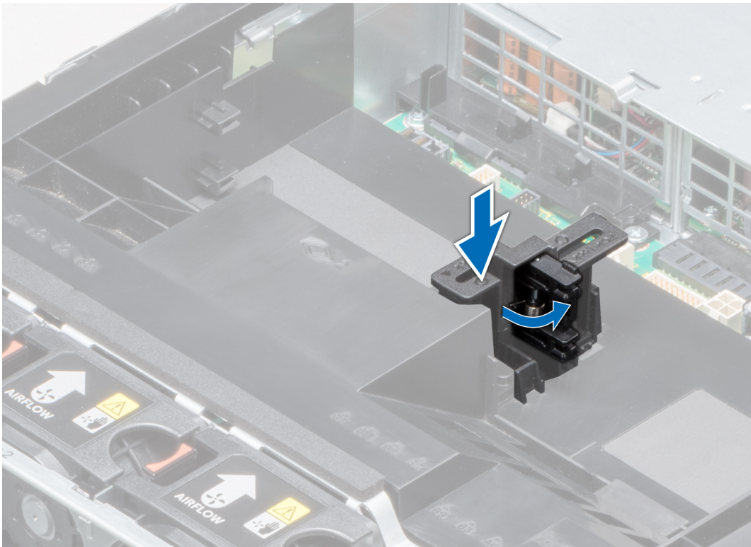
Figure 48. Ouverture du loquet du support de carte PCIe
