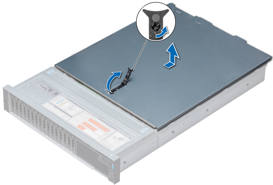
Figure 17. Retrait du capot du système
