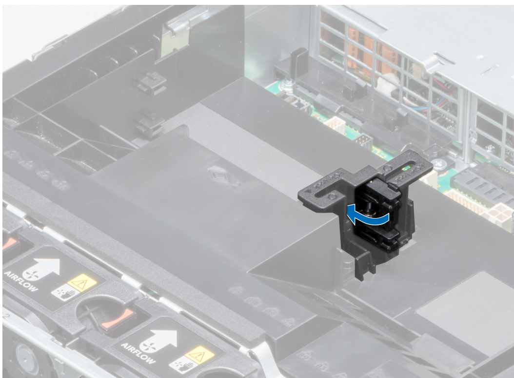
Figure 49. Fermeture du loquet du support de carte PCIe
