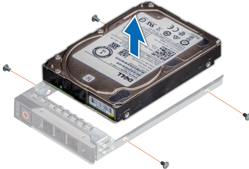
Figure 34. Retrait d'un disque dur installé dans un support
